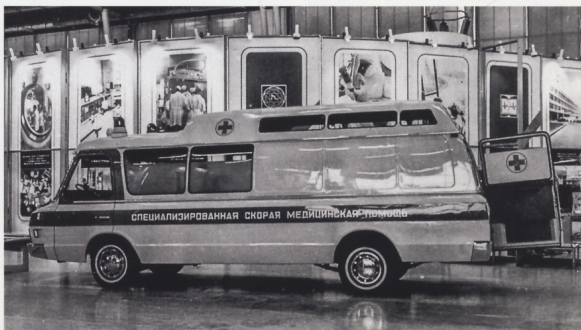
Для погрузки носилок в машину служила задняя распашная дверь
