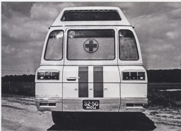
Для погрузки носилок в машину служила задняя распашная дверь
