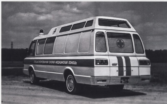
Для дневного освещения в надстройке кузова были сделаны дополнительные окна
